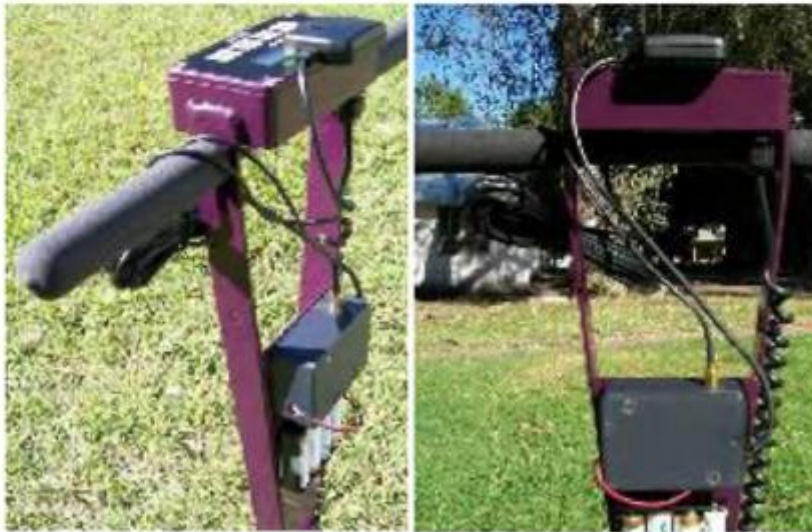
Figura 6: montaje del prototipo en el instrumento FieldScout TDR 300
