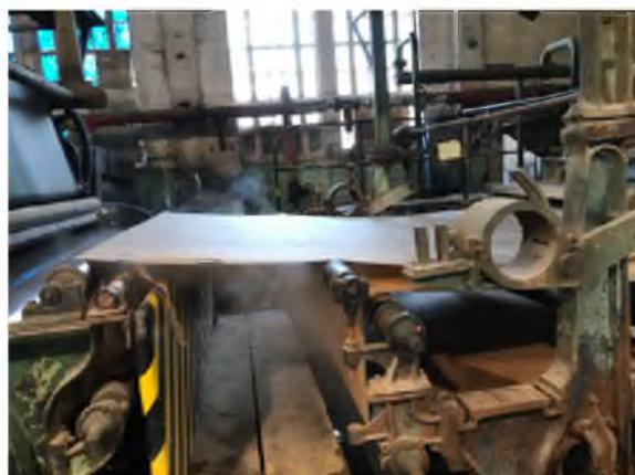
*Imagen 13: Lugar de transferencia del sector prensado al de secado. Fotografía propia.*
