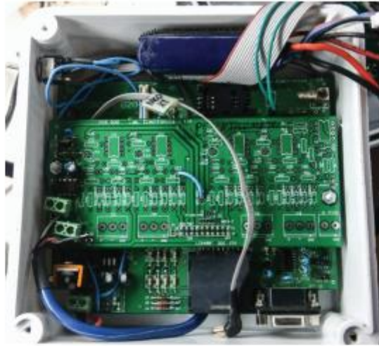
Figura 10: Sistema de adquisición de datos, placa principal y acondicionadora de señal.
