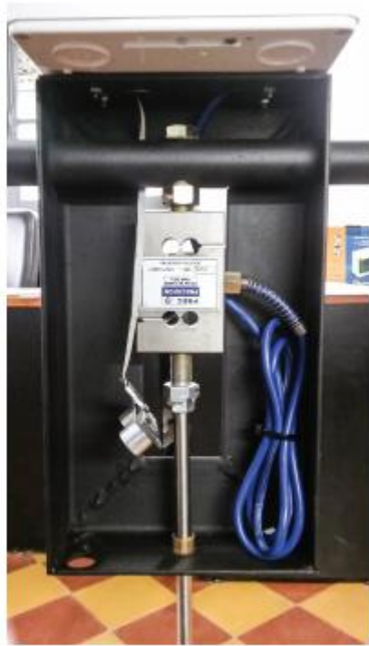
Figura 9: Instalación del elemento sensor en el gabinete (celda de carga)
