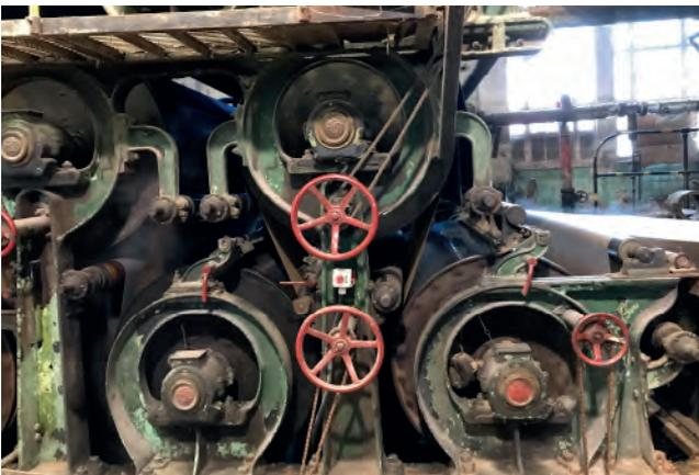
*Ilustración 10: Máquina 1, sector de secado. Fotografía propia.*
