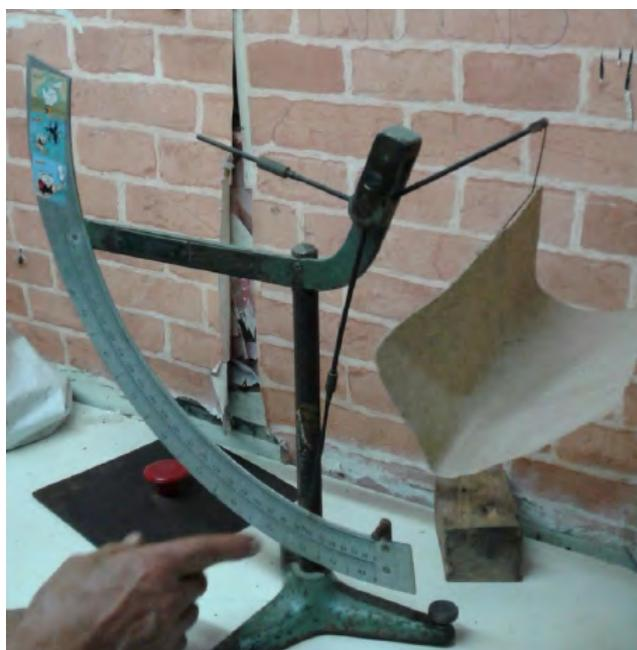
*Ilustración 20. "Balanza de precisión" para el control de calidad. Fotografía propia*
