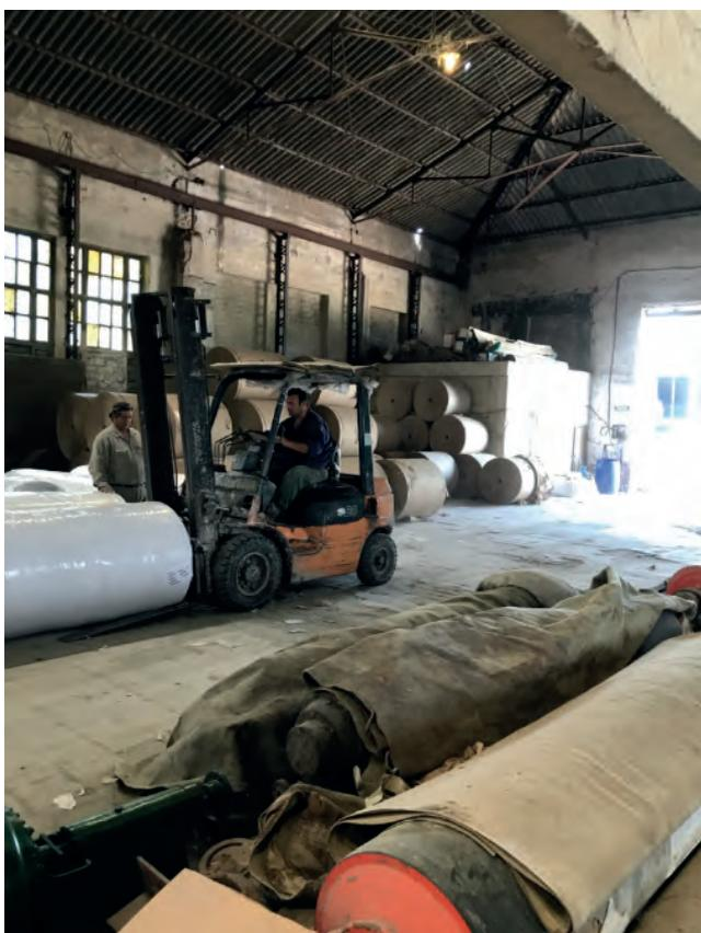
*Ilustración 19: Sampista cargando las bobinas. Fotografía propia.*
