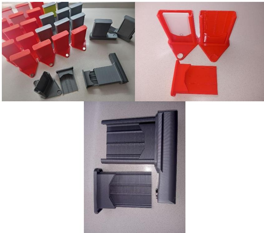
La figura superior izquierda presenta todos los soportes construidos. La figura superior derecha presenta el soporte para barril metálico. La figura inferior presenta el soporte para barril plástico en jaula de metal.
