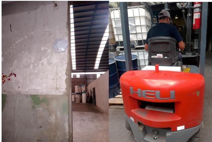
Instalación de un nodo BLE-LoRaWAN y una baliza BLE colocada en un clark.
